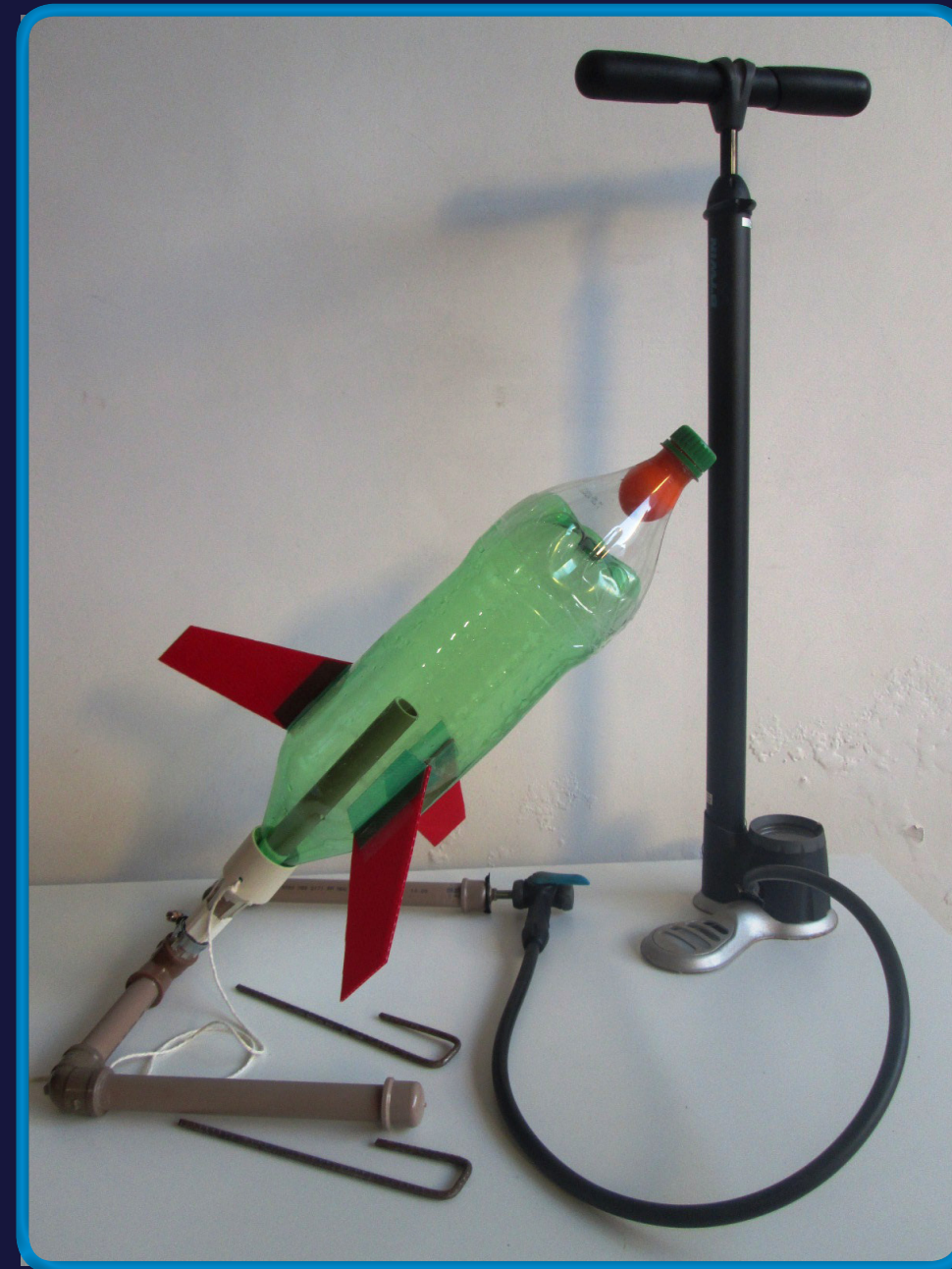
Imagem 11 - Foguete com a bomba de pressurização e os garrões que devem ser presos ao chão.
